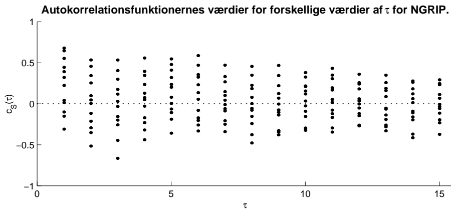
Figur 5.10: Værdier af kildesignalernes autokorrelationsfunktioner for forskellige værdier af \tau ved Dynamisk Dekorrelation af data fra NGRIP
