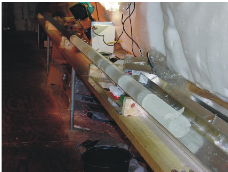
Figur 2. En netop udboret iskerne ligger klar til de første analyser.
